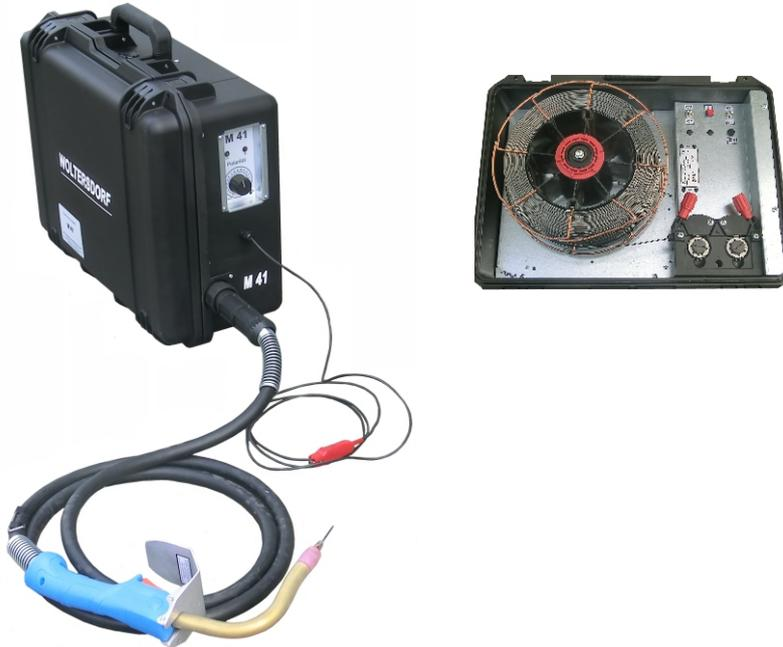
M 41 ist ein DV-Gerät mit DV-Spannungsbetrieb für MIG/MAG-Schweißen. Das Gerät ist universell einsetzbar für alle CC- und CV-Schweißstromquellen. Auch alte statische E-Schweißgleichrichter oder Elektordenschweißinverter können für das produktive MIG/MAG-Schweißen verwendet werden. Verbindung zur Schweißstromquelle nur über ein Elektrodenkabel.
