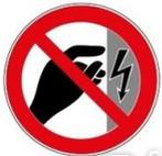
Beim Schweißen entsteht ein Stromkreis über den Brenner, das Werkstück (alle damit verbundenen Teile) und das Massekabel, zurück in die Anlage. Dieser Stromkreis darf während des Schweißens nicht direkt berührt bzw. unterbrochen werden.
